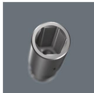
Das Sechskantprofil ermöglicht die Übertragung hoher Kräfte und belastet die Kanten der Schraubenmutter bzw. des Schraubenkopfes weniger als ein Zwölfkantprofil. Feinverzahnte Knarren machen darüber hinaus durch ihren kleinen Rückschenkwinkel den Einsatz eines Zwölfkantprofils auch in beengten Raumverhältnissen überflüssig.
