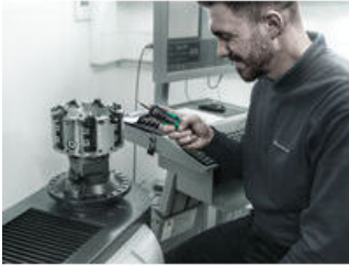
Drehmomentschraubendreher mit Schnelleinstellung
